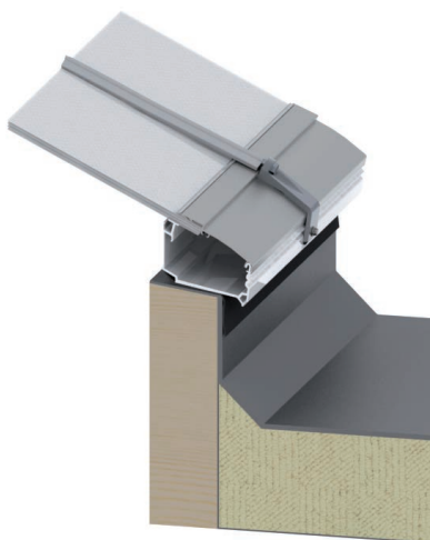
Montaż na kratownicy drewnianej
